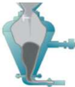
Insertion du produit dans le sas
